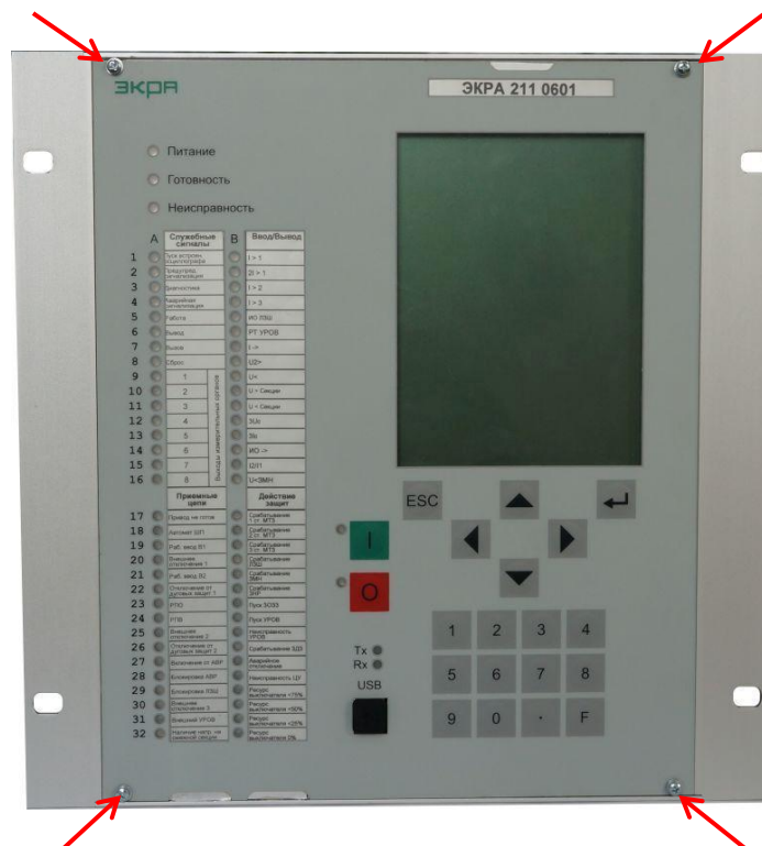
Рисунок 10 – Винты крепления блока индикации к cassette (на примере терминала ЭКРА 211)
